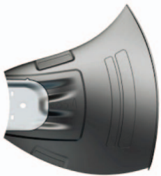
図2： HyBlade®ブレードの基本構造：高強度、耐腐食性アルミニウム合金製のブラケットに特殊な繊維強化プラスチックを射出成型しています。
